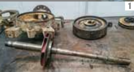
PHASES DE REMONTAGE D'UNE POMPE MULTICELLULAIRE WKL
